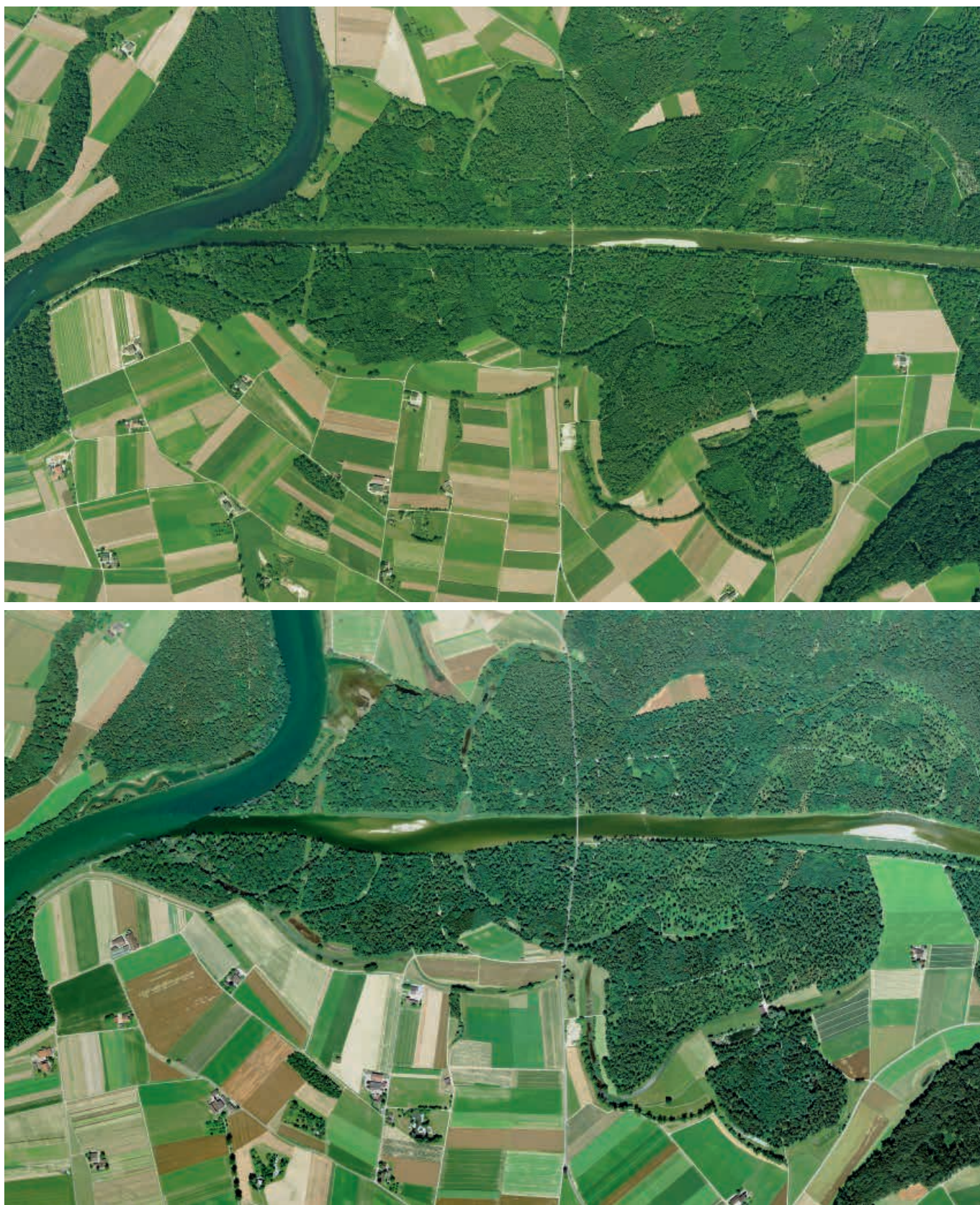
Abb.35 Die Mündung der Thur in den Rhein 1998 und 2016 nach der Renaturierung. Der Fluss kann sich neu in einem breiteren Bett bewegen, leicht mäandrieren und Sandbänke bilden. Bei Hochwasser kann die Thur in den Auenwald ausfliessen. Quellen: swisstopo
